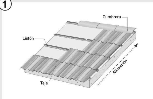
El montaje del techo con teja empieza de abajo hacia arriba con la teja entera de la derecha hacia la izquierda. Dependiendo de la división del techo, el lado extremo izquierdo termina con media teja o una entera. Si es necesario, corte la teja para ajustarla a las dimensiones del techo. El techo tiene que estar alineado horizontal y verticalmente.
