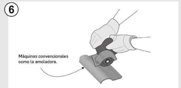
Si es necesario cortar la teja para ajustarla a la medida del techo o faldón, hagalo en la parte superior del techo cerca de la cumbrera y nunca en la parte inferior, en la cenefa. Para cortarlas utilice máquinas convencionales como la amoladora, con disco diamantado enfriado con agua. Para perforarlas, utilice una broca nueva de widia.
