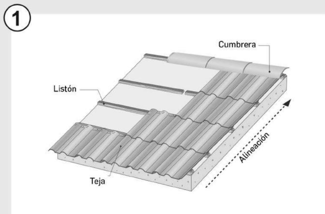
El montaje del techo con teja empieza de abajo hacia arriba con la teja entera de la derecha hacia la izquierda. Dependiendo de la división del techo, el lado extremo izquierdo termina con media teja o una entera. Si es necesario, corte la teja para ajustarla a las dimensiones del techo. El techo tiene que estar alineado horizontal y verticalmente.
