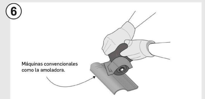
Si es necesario cortar la teja para ajustarla a la medida del techo o faldón, hagalo en la parte superior del techo cerca de la cumbre y nunca en la parte inferior, en la cenefa. Para cortarlas utilice máquinas convencionales como la amoladora, con disco diamantado enfriado con agua. Para perforarlas, utilice una broca nueva de widia.
